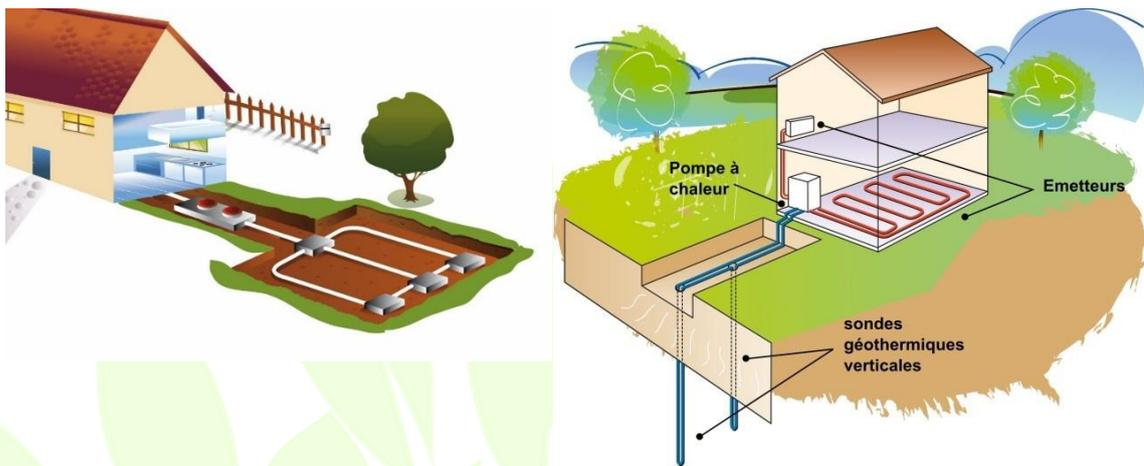
Figure 5 : Schéma d'un système d'exploitation de la géothermie (source : [planete-energies.com](http://planete-energies.com))
